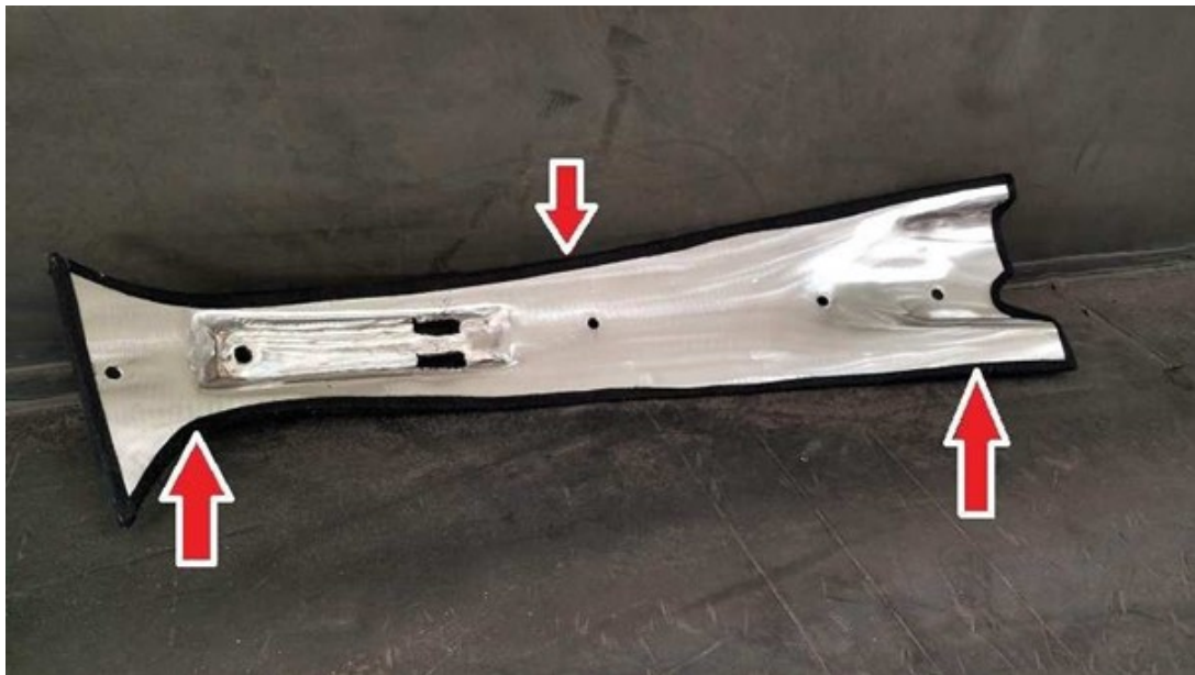
Figura 4 – Detalhe da aplicação da fita feltro nas bordas das chapas de aço
