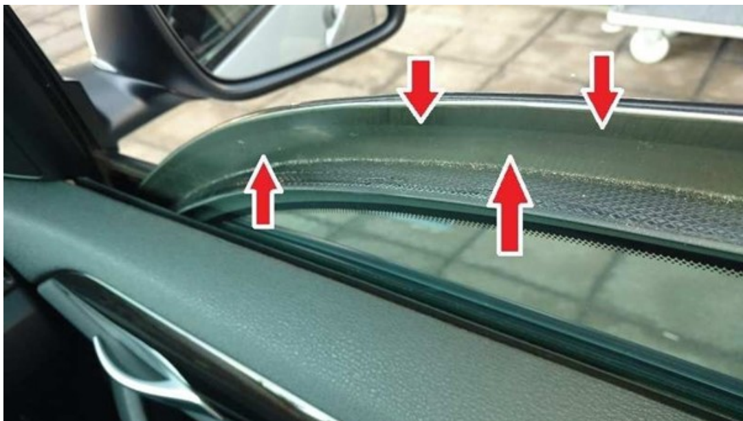
Figura 7 – Detalhe do reforço em aço na região do offset do vidro da porta dianteira
