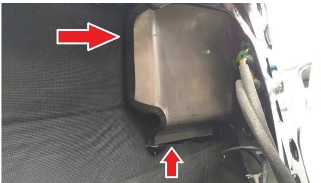
Figura 13 – Detalhe do reforço em chapa de aço inox na região da maçaneta
