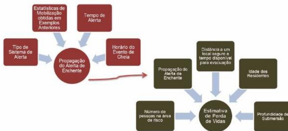
Figura 10: Considerações envolvidas na propagação do alerta de enchente Previsto no LIFESim e para estimativa de perdas de vida
